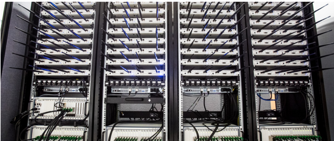
그림 3 브리스톨 대학교와 룬드 대학교는 NI 상용 하드웨어와 LabVIEW 소프트웨어를 조합하여 세계 최초로 128-안테나, 리얼타임 Massive MIMO 테스트베드를 구현했습니다. 이 솔루션에 대한 더 자세한 정보는 ni.com/Massive-MIMO 를 참조하십시오.
