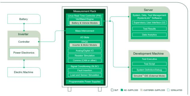
NI INVERTER TEST SYSTEM ARCHITECTURE
