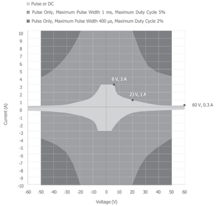
图7 脉冲模式下的SMU IV关系示例图
