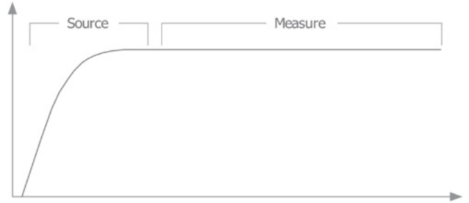
图4 SMU相对于采样信号的孔径时间示意图
