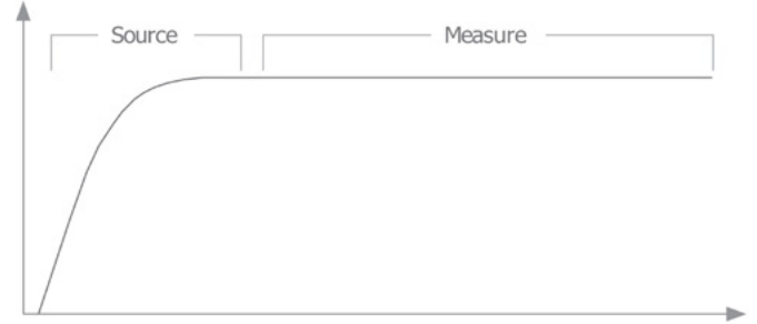
그림 4 샘플 신호에 대한 SMU의 애퍼처 시간에 대한 예시
