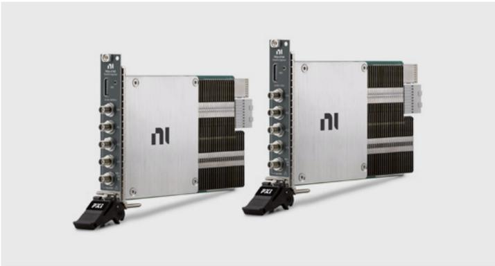
还可以从许多其他直流、模拟和数字仪器中进行选择，以实现更多测量功能 (图为PXIe示波器)。
