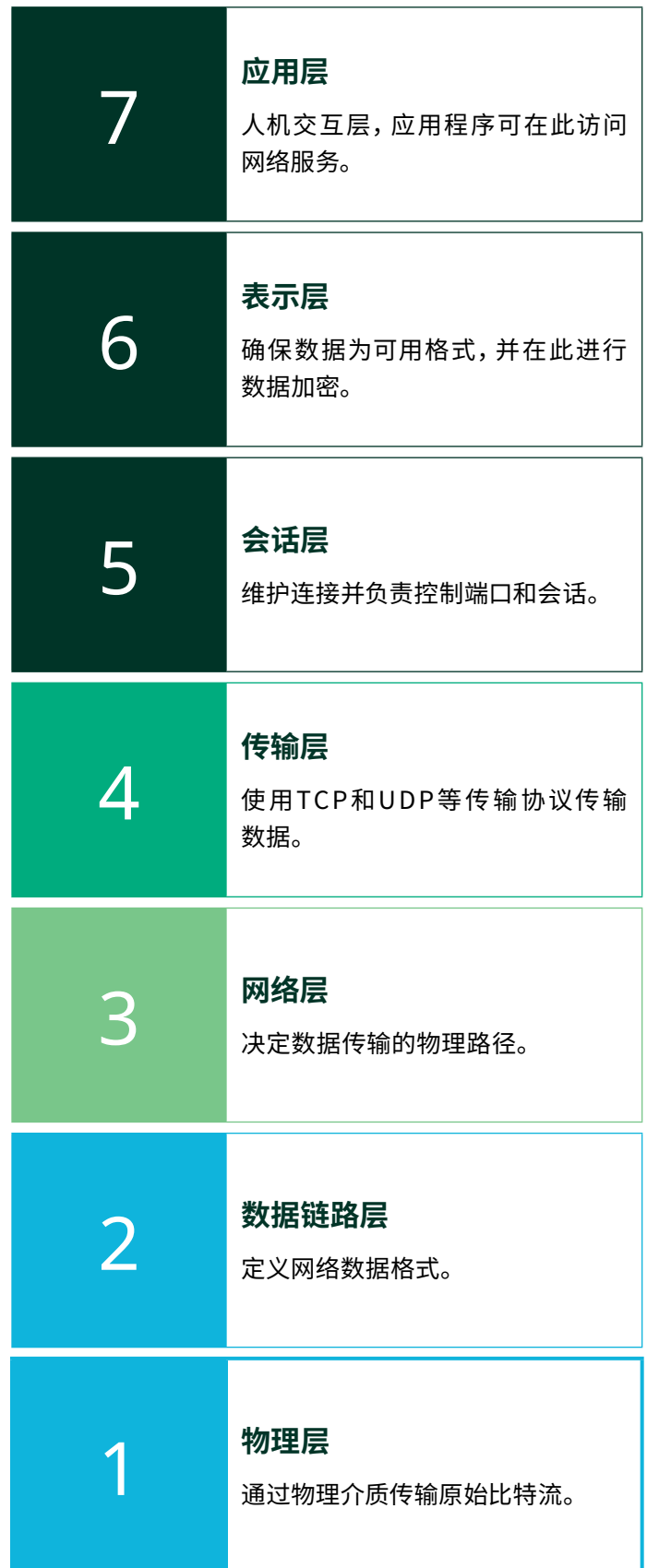
图1 OSI模型摘要,其中突出显示了物理层。
