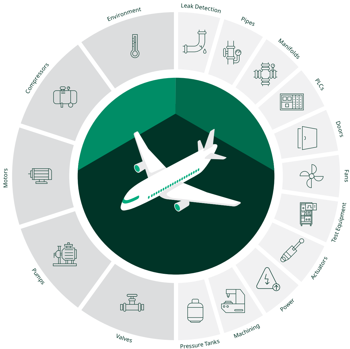
FIGURE 1 Ressources suivies dans le système de surveillance de l'état des installations
