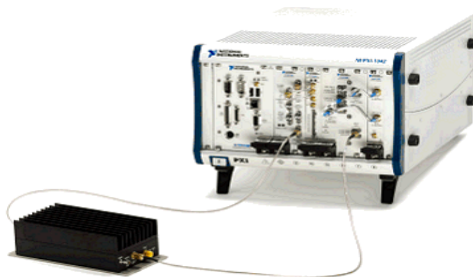
图 7 一个基于 PXI 和 LabVIEW 的 RF 合成仪器
