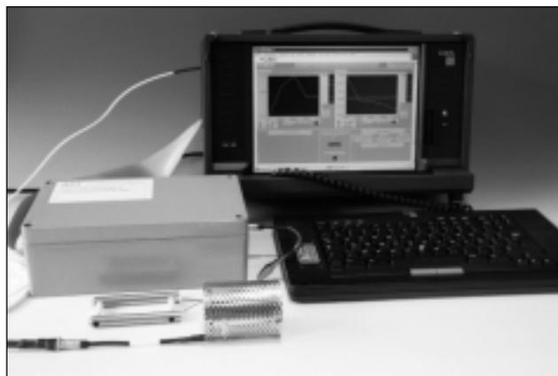
*Appareil portable pour l'analyse diélectrique*
